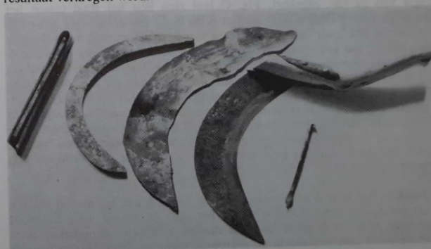
Tussenstadia van de vervaardiging van een riethaak; rechts de "houvast".
